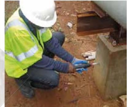
Test massif supportage tuyauterie (Depôt Kissy total S L)
